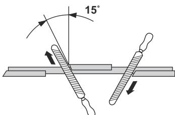
**Примечание:** Если диск сильно изношен, затачивайте кромки зубьев плоским напильником. Продолжите заточку круглым напильником.
